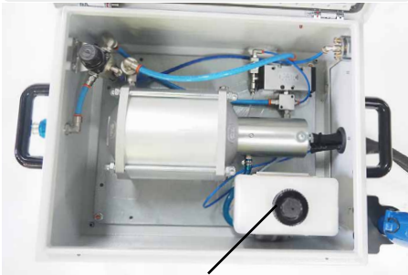
*Tanque bloqueado, quitar cierre de seguridad.
